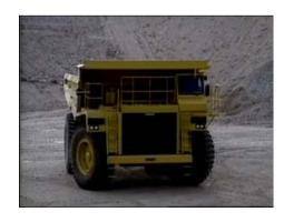
Básicamente un dumper está constituido por todos los componentes de un vehículo automotor, además de la **caja de carga**, en la que transporta material suelto de diversa naturaleza (arena y gravas, material volado y escollera). Esta caja suele ser basculante para permitir la descarga, aunque en la actualidad hay otros sistemas de descarga, en equipos especializados, donde no se podría levantar la caja para su descarga.
