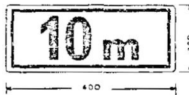
Fig. 8b. Indicador de estación de bajada a 10 m
